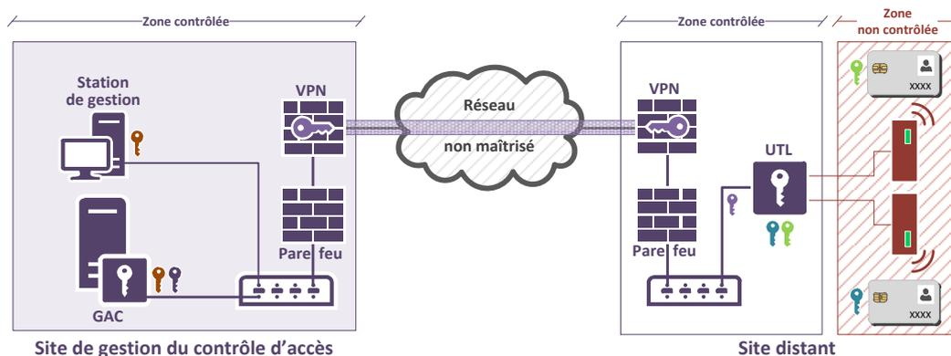
FIGURE 8 – Exemple de réseau fédérateur reposant sur un réseau de transport non maîtrisé
