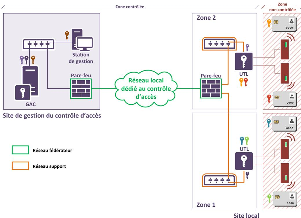
FIGURE 7 – Exemple d'architecture incluant plusieurs réseaux support
