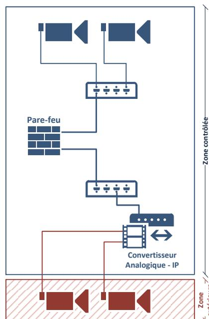
FIGURE 6 – Exemple recommandé de réseau support dédié aux caméras extérieures
