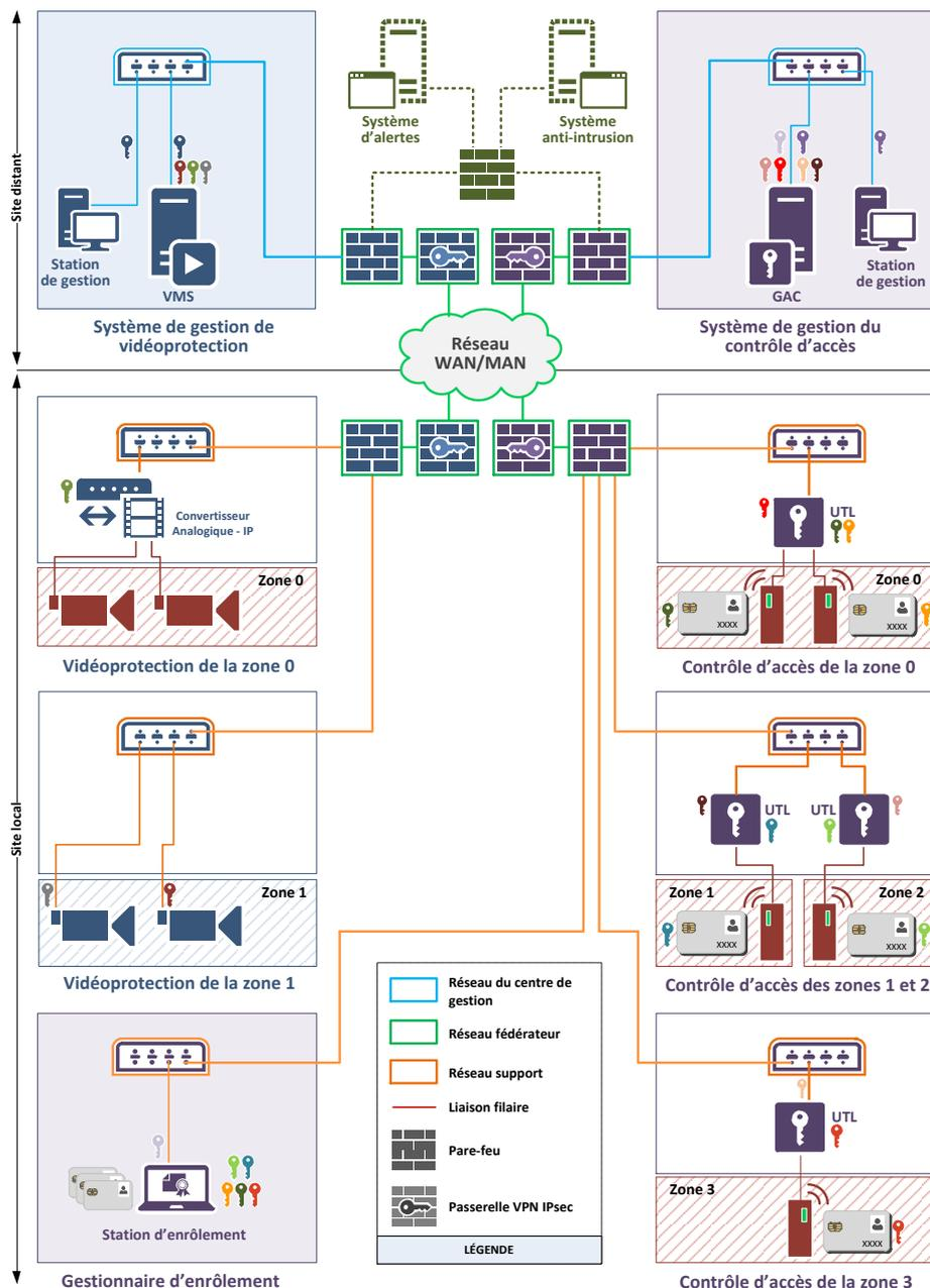
FIGURE 25 – Schéma d'architecture
