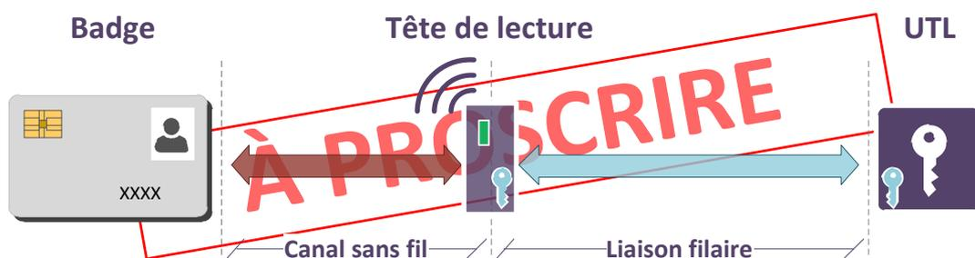
FIGURE 16 – Configuration type n°3 : Badge non sécurisé, avec chiffrement filaire seulement
