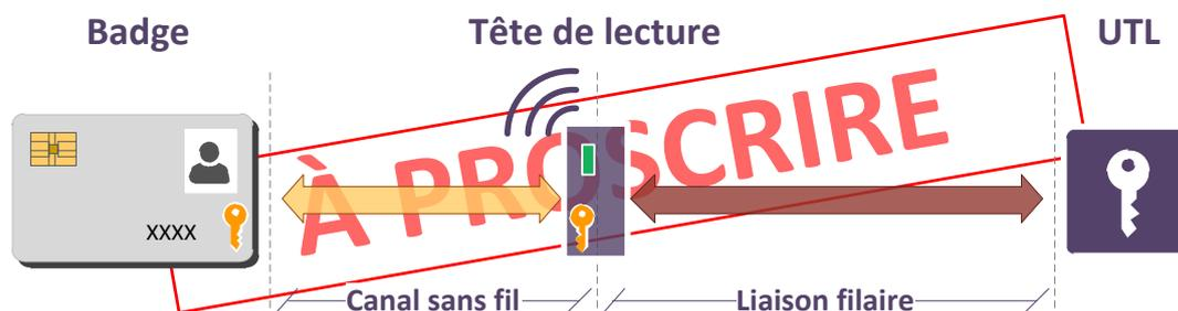
FIGURE 17 – Configuration type n°4 : Badge sécurisé, avec liaison filaire non chiffrée
