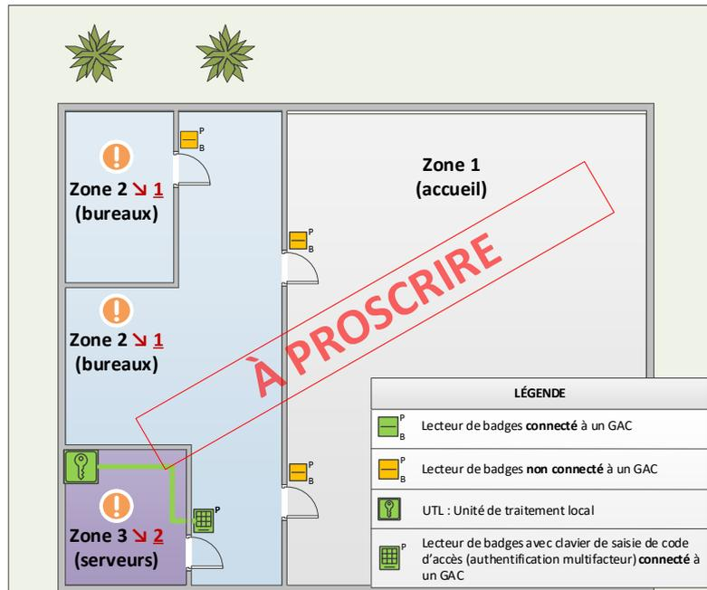
FIGURE 19 – Exemple d'architecture avec un contrôle d'accès physique sans gestion centralisée à proscrire
