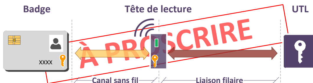
FIGURE 16 – Configuration type n°4 : Badge sécurisé, avec liaison filaire non chiffrée
