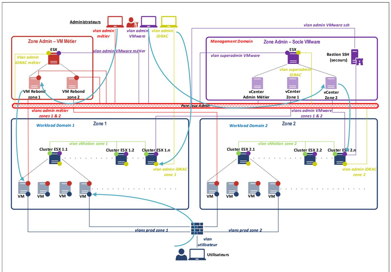
FIGURE 2 – Architecture d'administration VMware - Flux réseau
