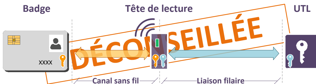
FIGURE 15 – Configuration type n°2 : tête de lecture intelligente, double authentification en coupure
