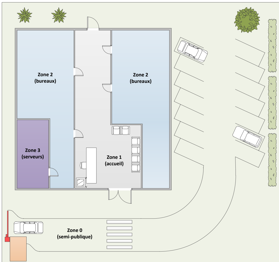
FIGURE 2 – Exemple de découpage d’un site en zones associées à des niveaux de protection attendus
