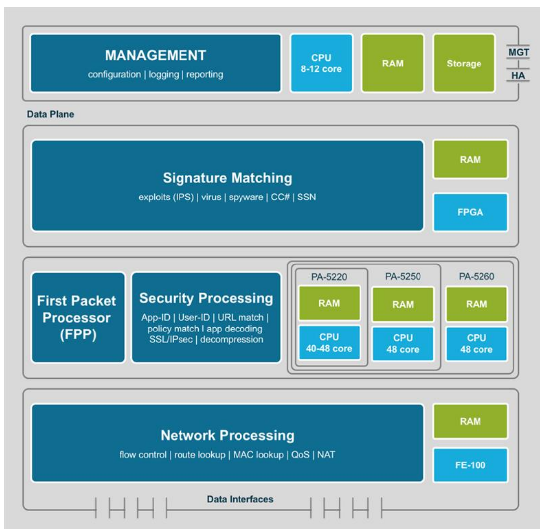
Figure 2 - Architecture des pare-feux de nouvelle génération de Palo Alto Networks
