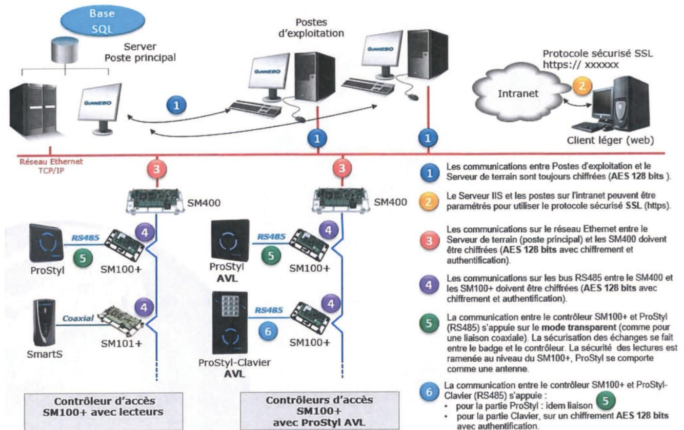
Figure 8 : Architecture SMI Server et échanges
