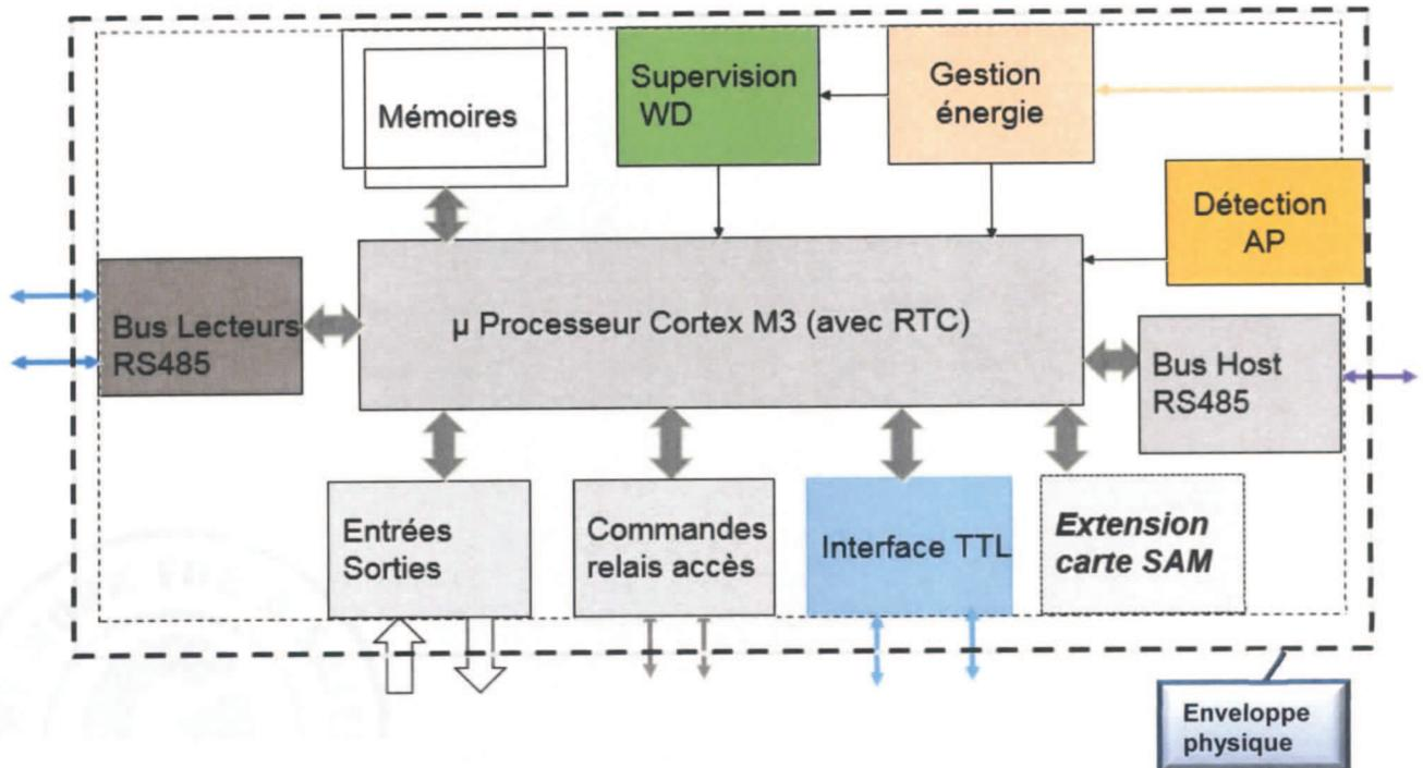
Figure 3 : SM100+ - Architecture technique (schéma de blocs)
