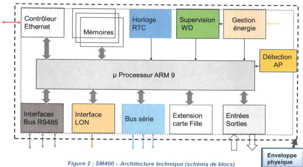
Figure 2 : SM400 – Architecture technique (schéma de blocs)
