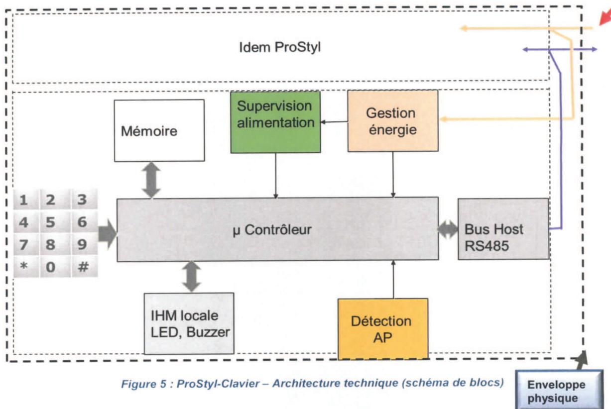
Figure 5 : ProStyl-Clavier – Architecture technique (schéma de blocs)
