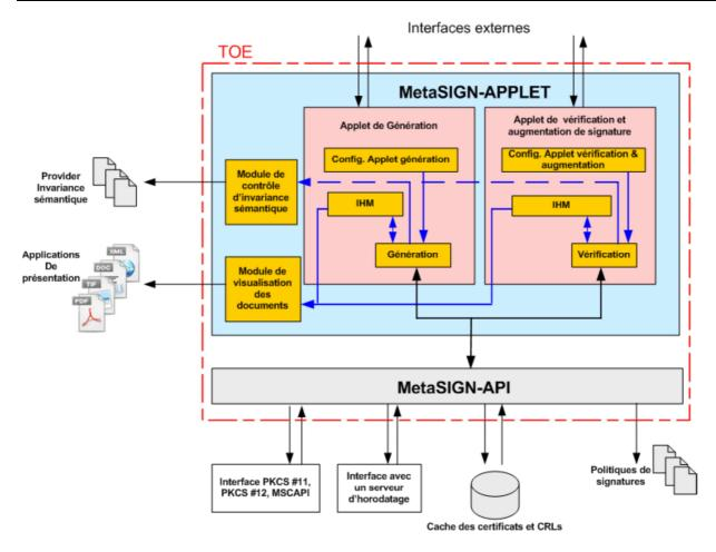
Figure 1 - Architecture et périmètre de la TOE (Target Of Evaluation)
