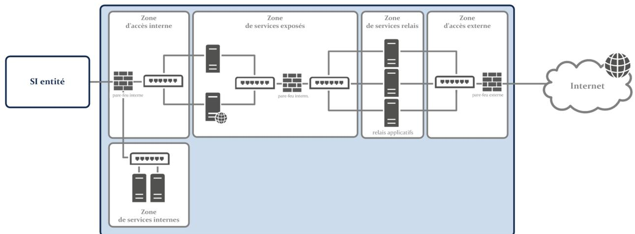
FIGURE 2.13 – Architecture recommandée d'une passerelle Internet sécurisée (avec zone de services exposés)
