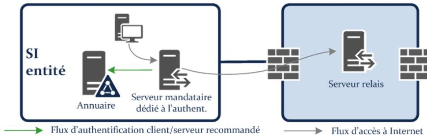
FIGURE 2.9 – Serveur mandataire au sein du SI de l'entité dédié aux besoins d'authentification de la passerelle Internet sécurisée et y transférant les requêtes
